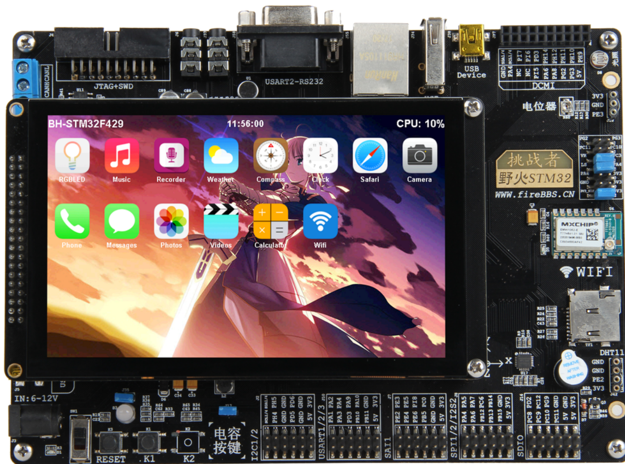
图野火【挑战者】F429/F767/H74 开发板带液晶效果图
