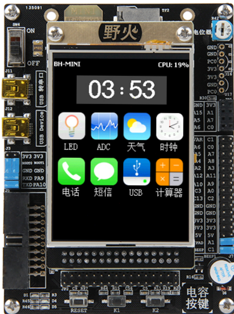
图野火【MINI】STM32F103RCT6 开发板带液晶效果图
