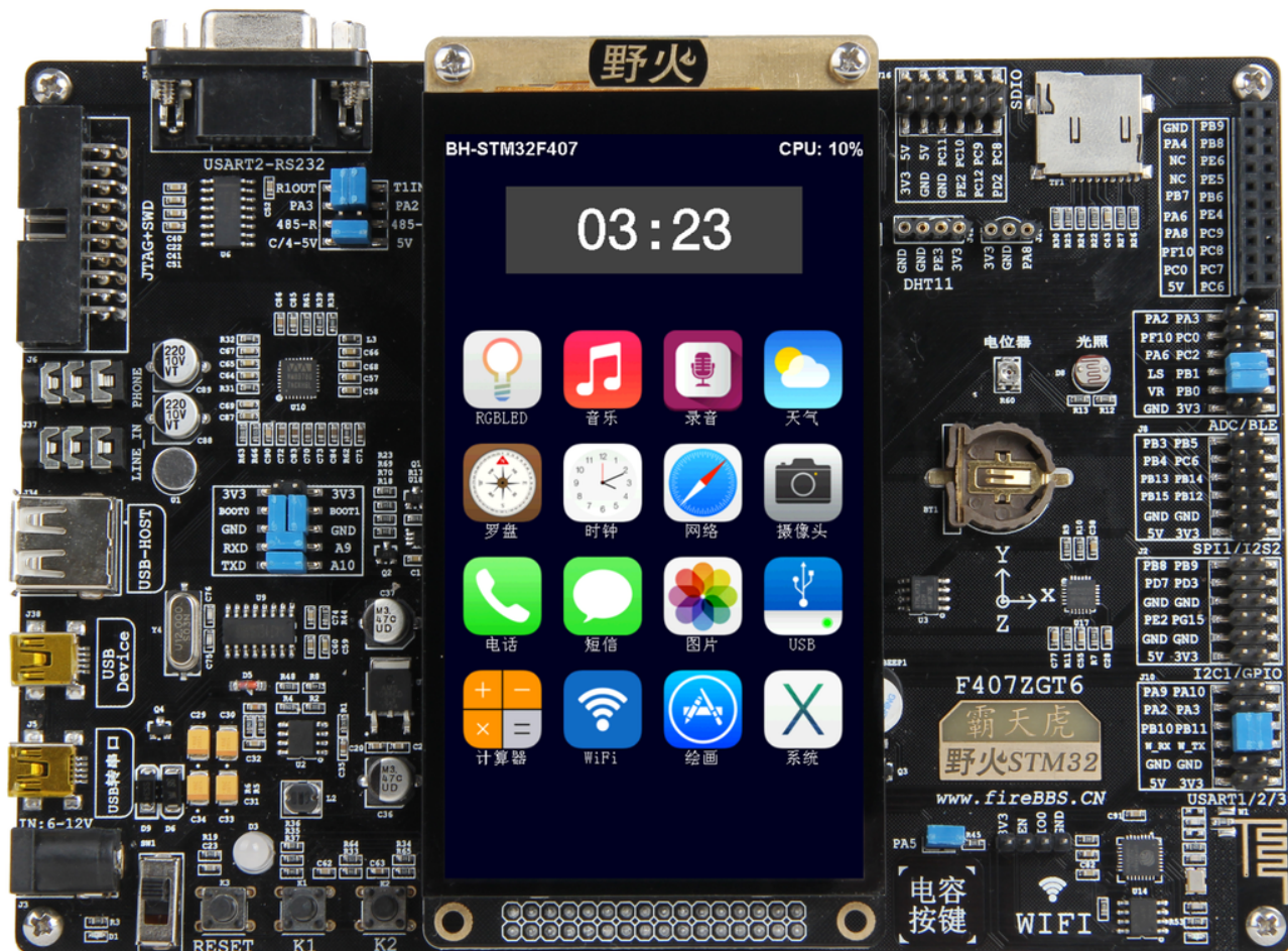
图 1-8 野火【霸天虎】STM32F407ZGT6 开发板带液晶显示效果图
